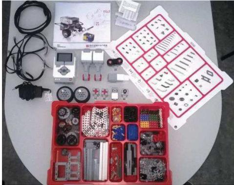
**Figura 1. Set de piezas, Brick, sensores, servomotores, conectores de LEGO MINDSTORM EV3.**
