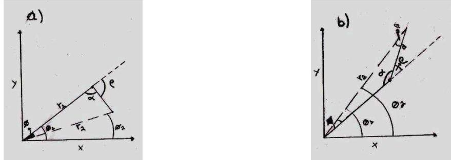
Figura 3 (a). Trayectoria del CASO 1,  $\theta_1 > \theta_2$ , giro en sentido de las manecillas del reloj. (b). Trayectoria del CASO 2,  $\theta_1 < \theta_2$ , giro opuesto al sentido de las manecillas del reloj.
