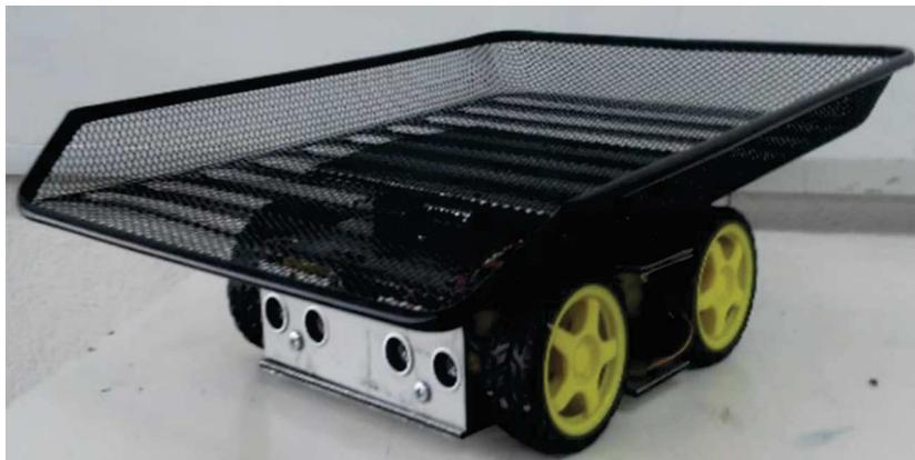
**Figura 9. Estructura flexible de diseño del robot móvil, en seguidor de línea**
