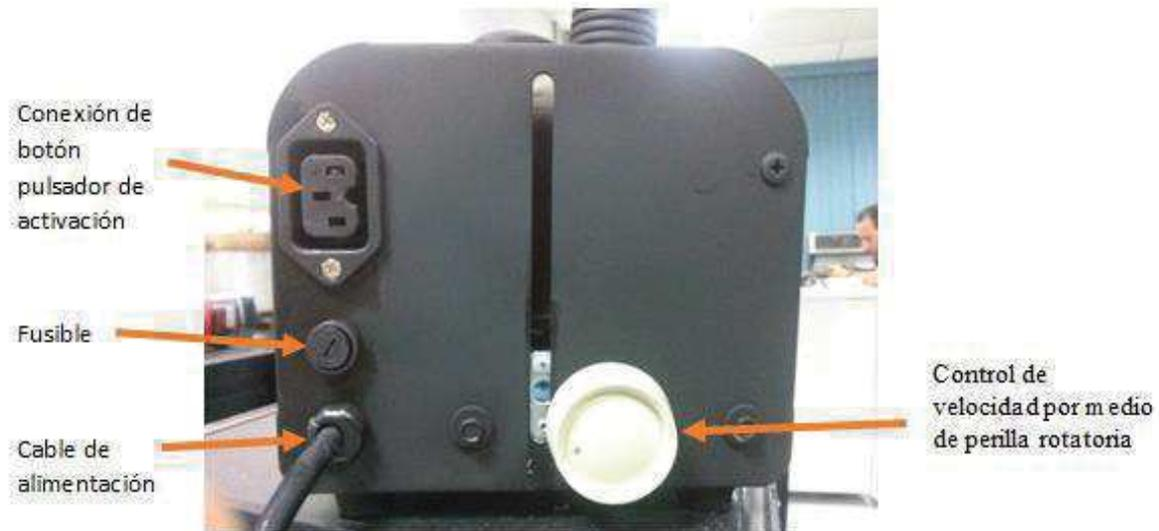
**Figura 10. Vista frontal del sistema desarrollado con sus conexiones correspondientes.**
