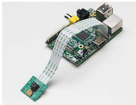
Figura 8: Unidad Central de Control (Raspberry Pi) y cámara
