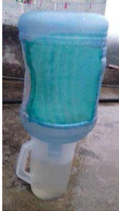
**Figura 10. Captador de niebla desarmable del sistema de Mantenimiento y de activación.**
