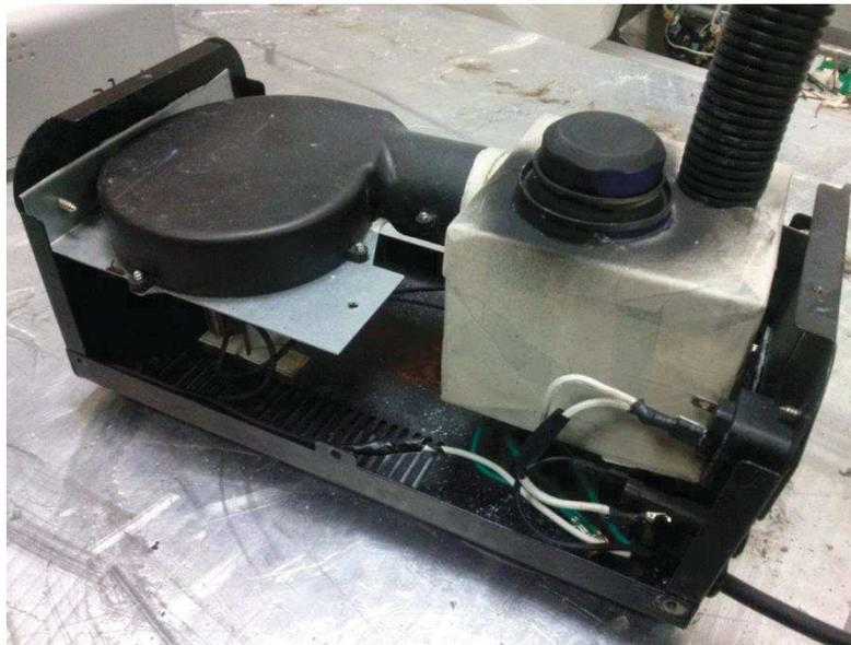
**Figura 4. Sistema de inyección de polvos finos armado.**
