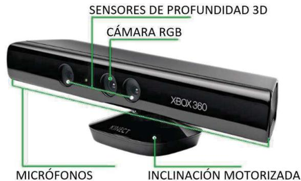
Figura 1. Kinect y sus componentes.
