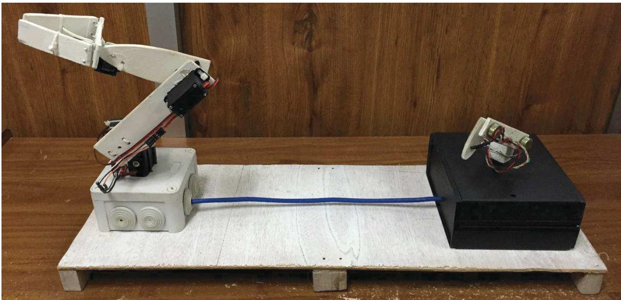
Figura 17. Modelo físico construido del brazo robótico y de brazo de control (control paralelo) después de las pruebas.
