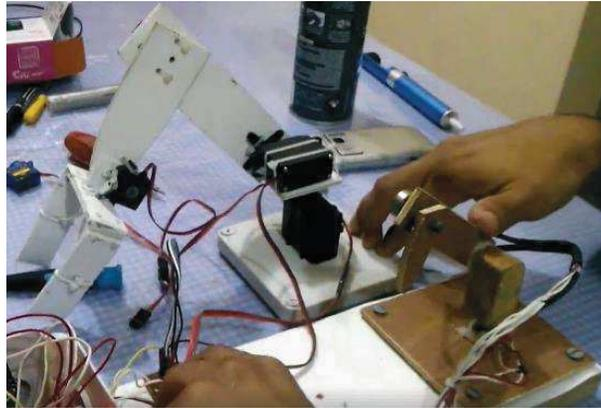
Figura 16. Pruebas del Modelo físico construido del brazo robótico y de brazo de control (control paralelo)
