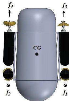
Figura 4: Fuerzas  $f_i$   $i = [1, \dots, 4]$  generadas por los cuatro propulsores del  $\mu$ -vehículo. CG denota la posición del centro de gravedad.
