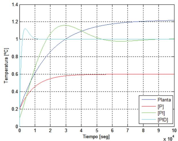
Figura 13. Respuesta de los controles calculados.
