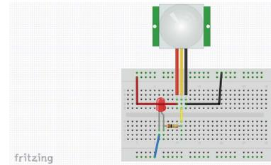
Fig 4. Esquema sensor de proximidad
