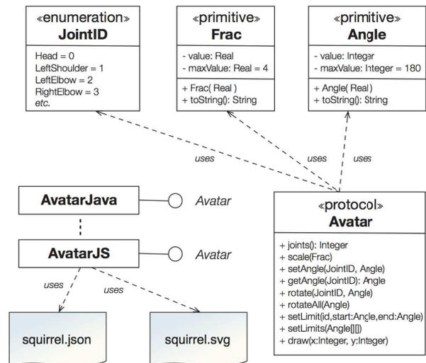
Fig. 5. Diseño del API representado en UML 2.5
