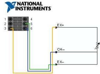
Figura 3. Conexión del sensor PT-100 al módulo NI 9219.
