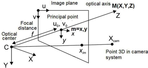
Fig. 5. Pinhole Camera.
