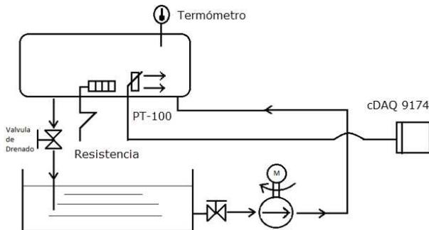
Figura 2. Diagrama de sensores y actuadores del proceso DL 2314.
