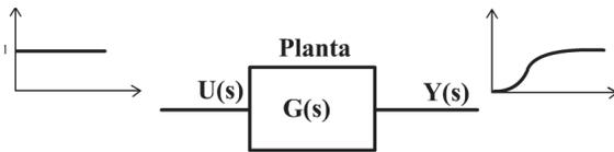
Figura 5. . Respuesta de la planta en Lazo Abierto.
