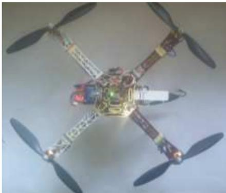
Fig.7. Quadcopter frame DJI 450.
