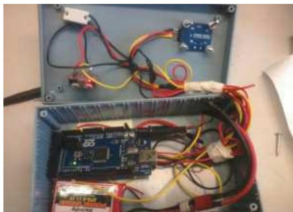
Figura 9. Componentes que conforman el control del robot móvil.
