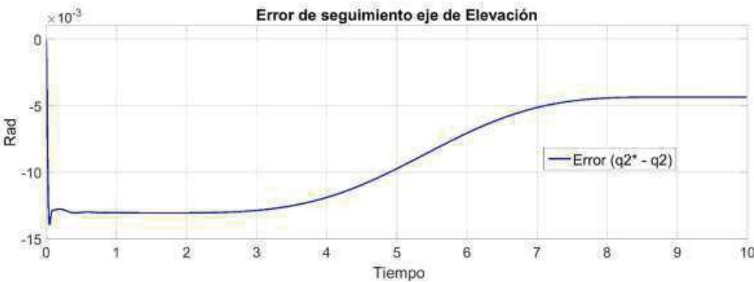
Fig. 10: Error de seguimiento (eje de elevación).
