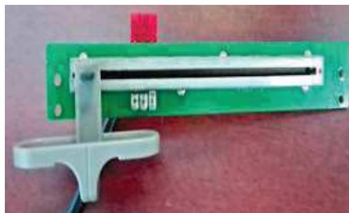
Figure 4. Potenciometro lineal empleado.
