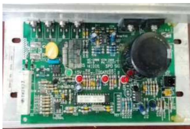
Figure 3. Tarjeta de controlador MC-60.
