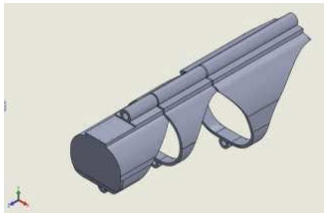
**Figura 9** Ensamble del exoesqueleto para el dedo índice
