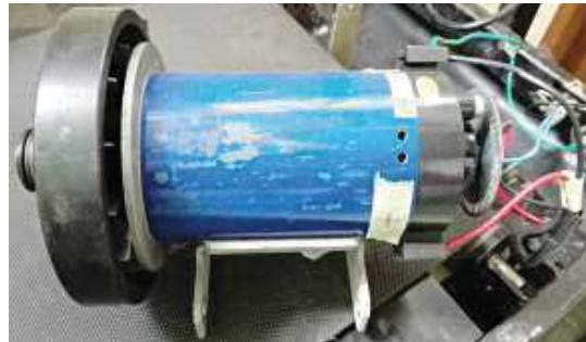
Figure 5. Motor de corriente directa.
