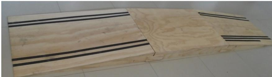
**Figura 7. Rampa de prueba con inclinación de 10 grados.**
