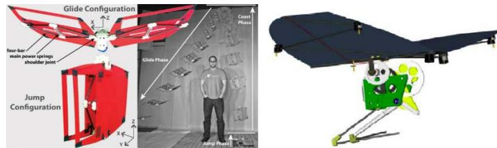
**Figura 8. Robots basados en el enfoque de diseño integral, el robot de la izquierda se encuentra inspirado en la locomoción de un murciélago, ambos son capaces de saltar y planear [34,35].**
