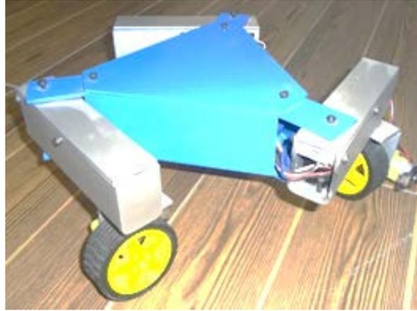
**Figura 9. Robot omnidireccional en su segunda versión.**
