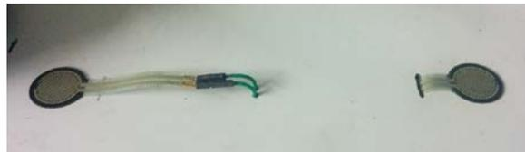
**Figura 35. Posicionamiento de sensores de fuerza resistivo.**
