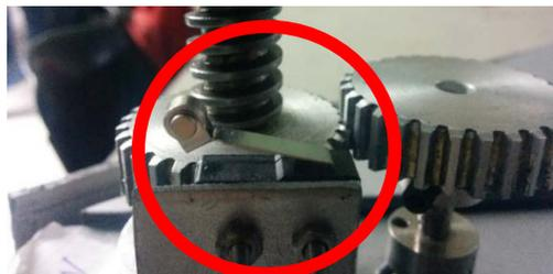
**Figura 18. Posicionamiento en final de carrera**
