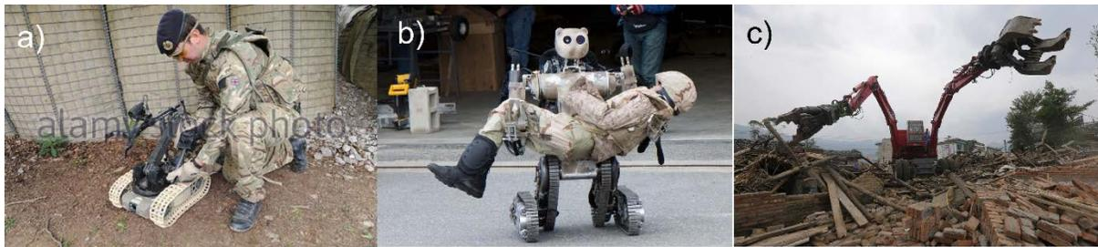
**Figura 52. Tamaño en los robots de rescate: a) man-packable, b) man-portable, c) maxi-sized.**
