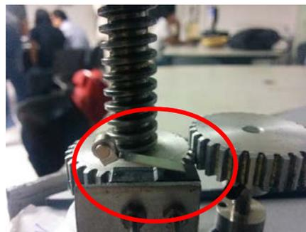
**Figura 36. Posicionamiento de los sensores finales de carrera.**
