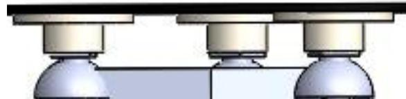
**Figura 7. Diseño de la articulación esférica mediante juntas.**
