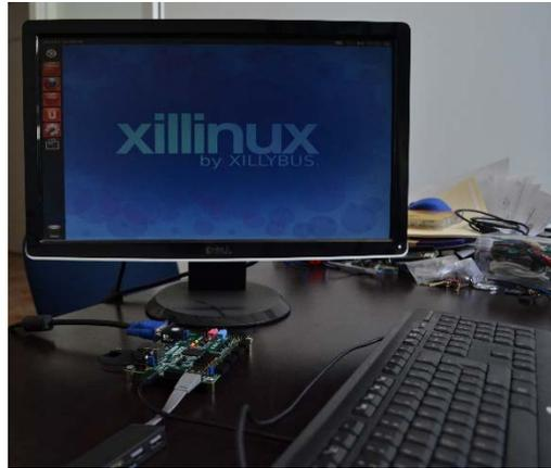
Figura 82. Xilinx instalado en la tarjeta Zybo.
