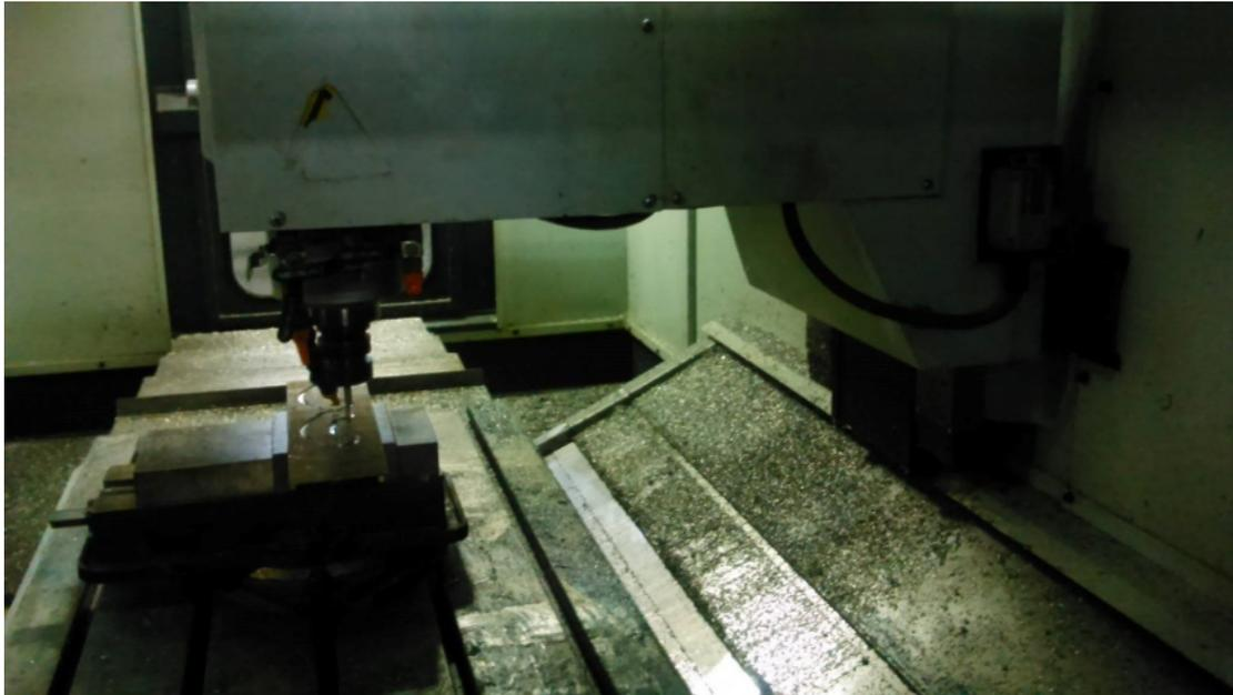
Figura 5. Centro de maquinado realizando la fabricación de una pieza.
