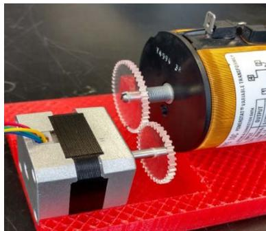
Figura 3. Acoplamiento mecánico del cursor del VARIAC con el motor a pasos.
