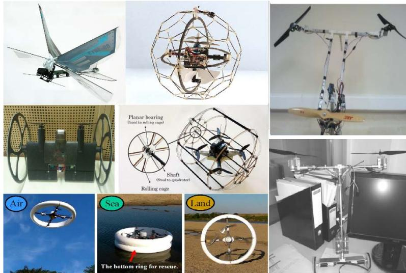
Figura 7. Robots móviles con sistemas de locomoción terrestre-aéreo bajo el enfoque semi-aditivo [27-33].
