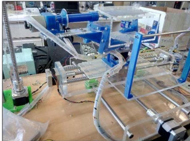
**Figura 4. Sistema de impresión de biomateriales 3D con acoplamiento de electrotejido.**
