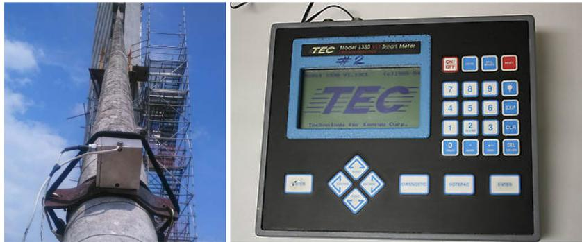
Figura 12. Montaje del acelerómetro sobre el tirante (izquierda) y sistema portátil de mediciones de vibraciones (derecha).
