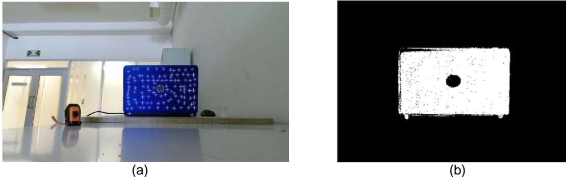
Figura 4. Interfaz de salida al momento de usar la función *impixel()* (a) e imagen binaria con color segmentado (b).
