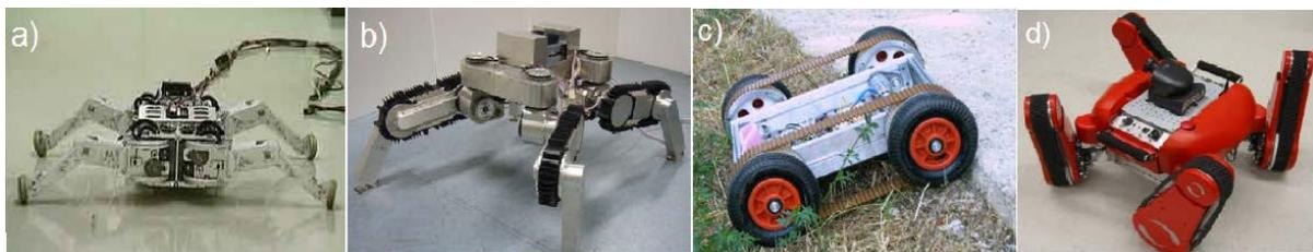
**Figura 5. Robots con sistemas de locomoción híbridos: a) extremidades con ruedas (L-W) [17], b) extremidades con orugas (L-T), c) ruedas con orugas (W-T) [19], d) extremidades con ruedas y orugas (L-W-T) [23].**
