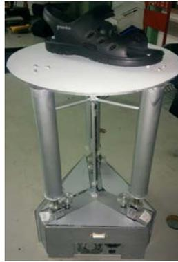
**Figura 34. Estructura del robot paralelo.**
